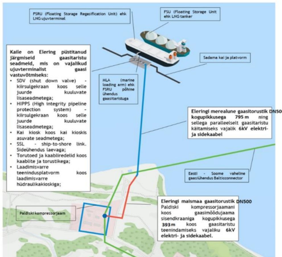
Joonis 3.5 Pakrineeme FSRU haalamiskai plaan
