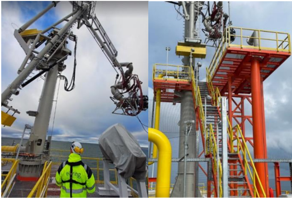
Joonis 3.6 Pakrineeme FSRU laadimiskäpp ja laadimiskäpa teenindusplatvorm
