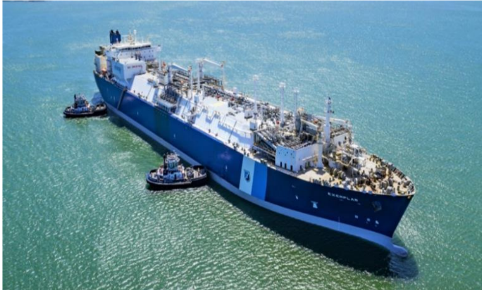
Joonis 3.3 LNG taasgaasistamise võimekusega LNG tanker (FSRU)
