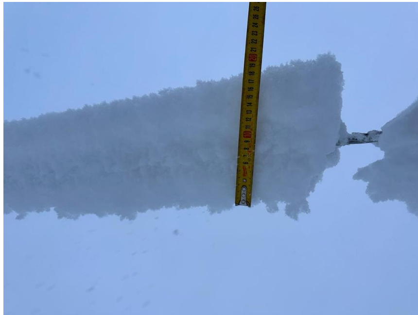
Joonis 2.16 Lumi õhuliini juhtmel
