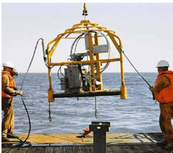
Joonis 8.1. Tavaline koonuse tüüpi läbistuspuur. Muude testide hulgas sisaldab merepõhja uuringu proovide võtmist, et vaadelda merepõhja geotehnilisi omadusi
