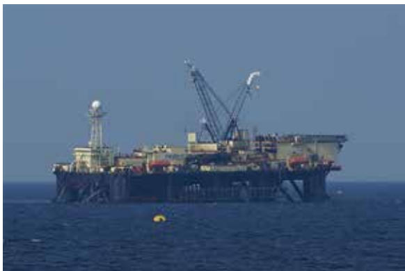
Joonis 1.11. Tüüpilised gaasijuhtme paigaldusalused - DP alus (Solitaire) ja praam (Castroro Sei)
