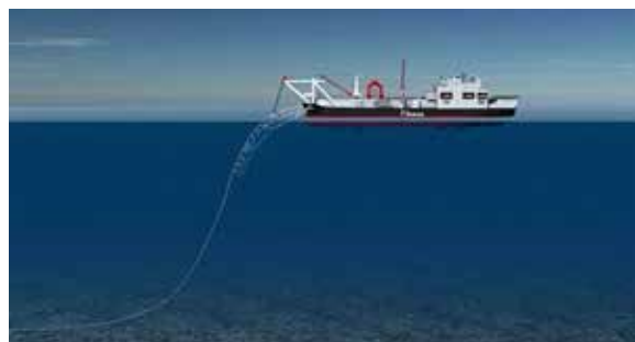
Joonis 2. S-tüüpi torupaigaldus alus (Allseas Group S.A. kodulehekül, 2013)
