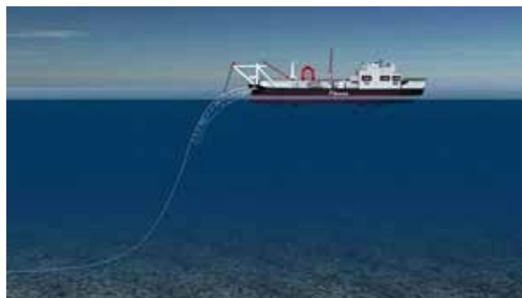
Joonis 1.12. S-tüüpi torupaigaldus alus (Allseas Group S.A. kodulehekülj, 2013)
