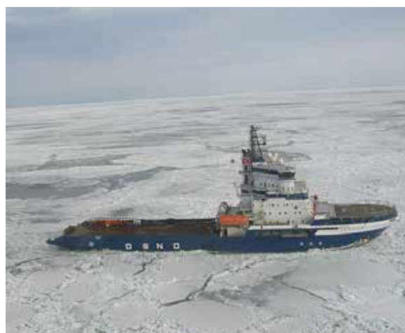
Joonis 3.5. Jäälõhkujad hoiavad veeteed lahti, lõigates vajadusel kanaleid laevade ees (Marcusroos, 2007)
