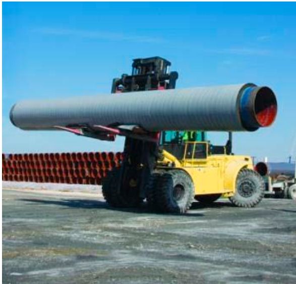
Joonis 3-2. Koostetoru (musta) polüetüleenkattega betoonkatte sees (Ramboll 2013).
