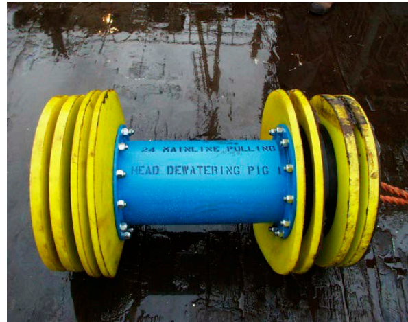
Joonis 3-20. Tüüpiline veetustamise „pig“ seade (Ramboll 2014a).
