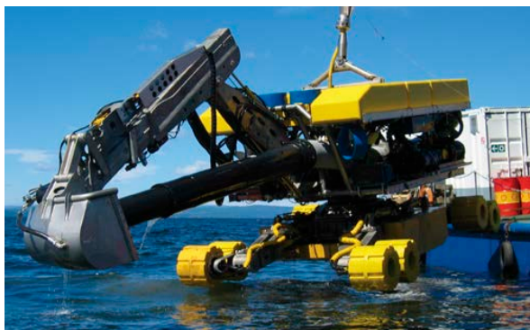
Joonis 3-6. Süvendamistehnikad. Vasakul on näidatud kaugjuhitav "spider-ekskaator" ja paremal süvenduspraam ning laadimisalus (Ramboll 2014a).
