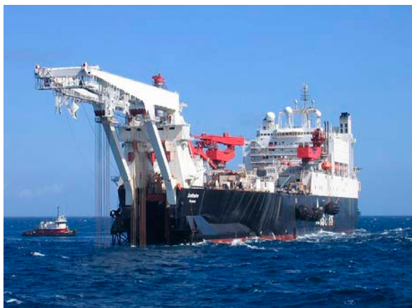
Joonis 3-12. Tüüpilised torupaigaldusalused – dünaamiliselt positsioneeritud torupaigaldusalus ( Solitaire , vasakul) ja ankurdatud torupaigaldusalus ( Castoro Sei , paremal) ( Ramboll 2013 ).
