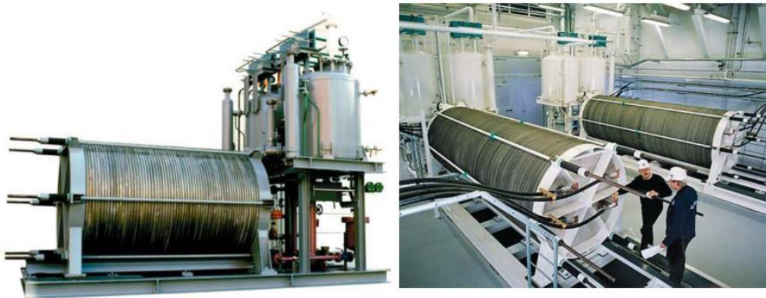
Joonis 2.6.3a Vesiniku aluselise elektrolüüdiga elektrolüüserite moodulid (NEL)
