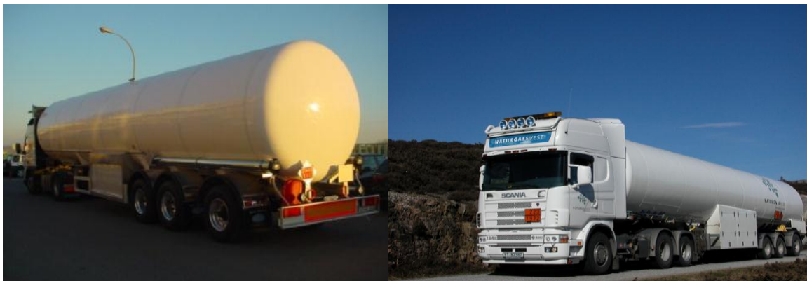
Joonis 16. Tsisternautod mahuga 56 m 3 LNG transportimiseks
