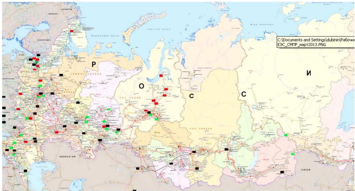
Joonis 2.24. Venemaa elektrisüsteemi paigaldatud PMU -d. Punased kastid – on-line töötavad PMU , mustad kastid – off-line töötavad PMU -d, ja rohelised kastid – kahe aasta jooksul paigaldatavad PMU -d [13].
