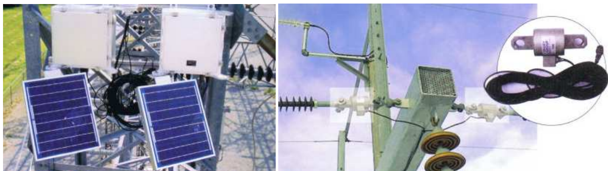
Joonis 4.6. Mehaanilisel tõmbel põhinev ülekandeliinide seiresüsteem CAT-1 (vasakul CAT-1 põhiseade, paremal mehaanilise tõmbe andurid) [6].
