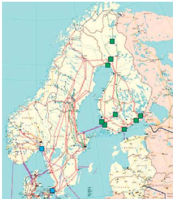
Joonis 2.18. Soome laiseiresüsteemis olevate PMU -de asukohad [9].
